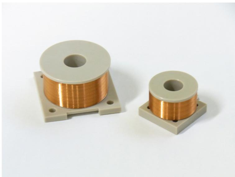
図 A.1: コイル-コイル アクチュエータに使用したコイル
