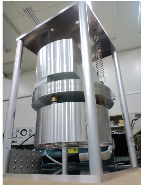
図 3.3 製作された振動子の写真
