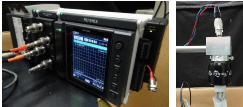
図 4.16: 使用した無線データロガー (左) とロータリーコネクタ (右)。
