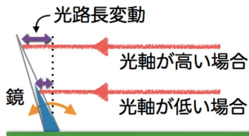
図 4.7: 光学系の振動によって鏡が揺れた場合の光路長変動。光軸を低くした方が光路長変動は小さくなる。
