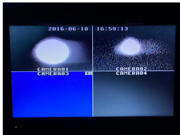
図 4.10: 同時共振時の透過光のプロファイル。左上が  $s$  偏光の透過光のプロファイルを表し、右上が  $p$  偏光のプロファイルを表す。
