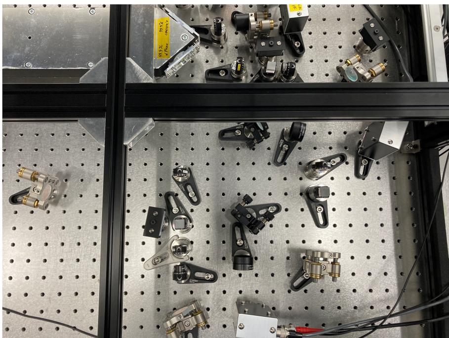
図 C.3: 入射光学系 (共振器への入射ポート)。
