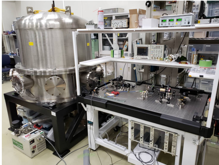
図 5.2: 実験装置全体の写真。右側の光学定盤が入射光学系、左側が直径 1 m の大真空槽 E-1 である。左下に真空ポンプを配置した。
