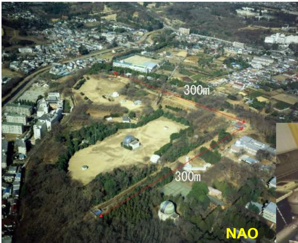
基線長300mレーザー干渉計
