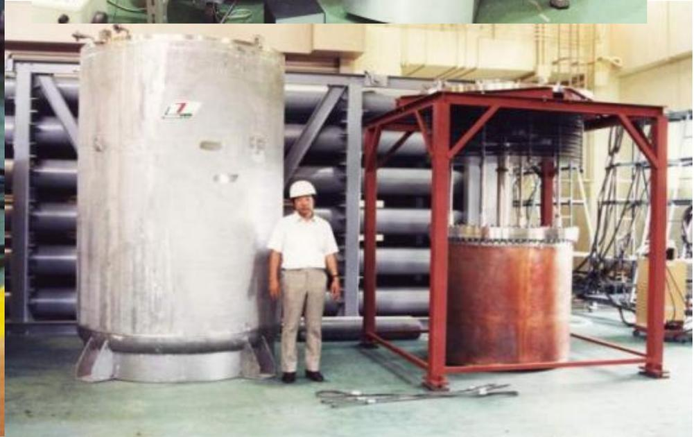
極低温を利用した高感度重力波アンテナ（ねじれ型）
