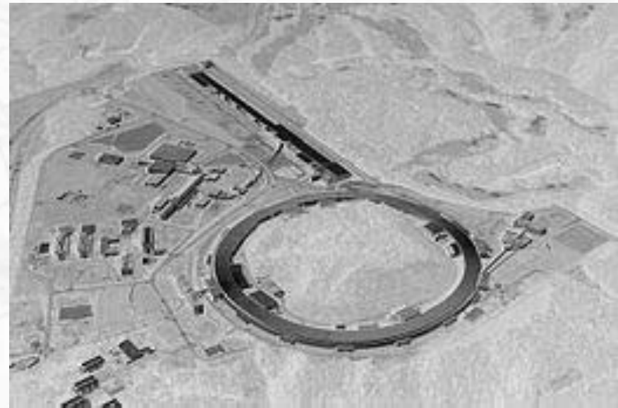
大型放射光施設 SPring-8 (JASRI) 最大エネルギー: 8GeV, 周長 :1,436m
