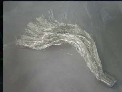
防振用ヒートリンク 銅線 (銀コーティング)
