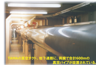
TAMAの真空ダクト。地下通路に、両腕で合計600mの真空パイプが設置されている。
