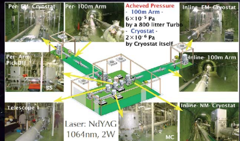
CLIO : 100-m cryogenic interferometer
