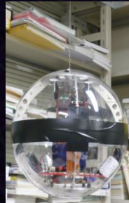
落下実験用 予備試験セットアップ
