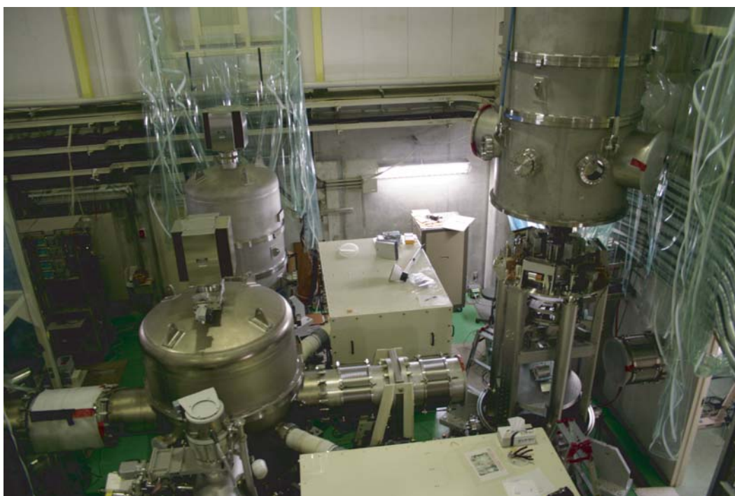
図 13.5: TAMA300 に組み込まれた SAS (右側のタンク)。
