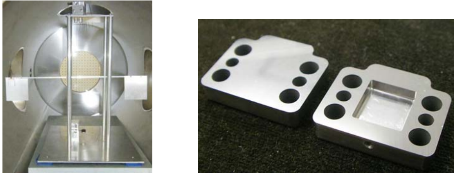
図 2.9: 左図: Torsion balance 式推力スタンド ( 60cm の真空チャンバ内に設置) . 右図: スリット型 FEFP/BBM-1 (26mm × 19mm × 10mm) 試作品
