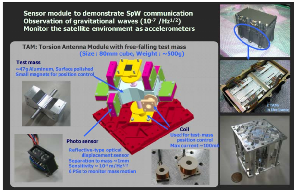
図 2.2: SWIM に収められた超小型重力波検出器モジュール . 質量 50 g 程度のアルミニウム製の試験マスが非接触浮上制御される .
