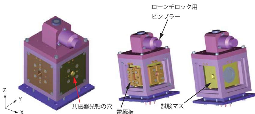
図 4.3: 周辺機器も含めた試験マスモジュールの概略図。
