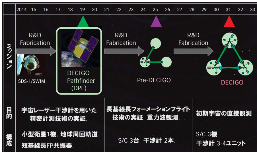
図 2.5: DECIGO 実現までの開発ロードマップ。2024 年の DECIGO 実機の打ち上げ前に、2 回の前哨ミッション (DECIGO Pathfinder, Pre-DECIGO) を打ち上げる計画になっている。その最初のものが、本提案書の DPF である。
