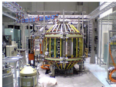
TST-2 球状トカマク装置（柏キャンパス）。中央に見える真空容器の中に磁場で閉じ込められた高温プラズマが生成されます。
