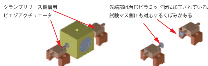
図 1.6: クランプリリース機構．ピエゾを用いた精密動作が可能な補助アクチュエータである．試験マスの精密位置決めを行う．
