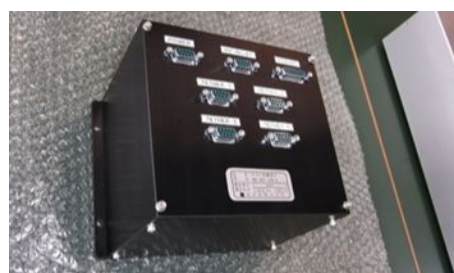
図 3.11: FEC 電源制御部の実験室モデル。
