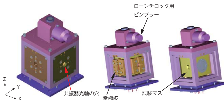
図 1.3: 周辺機器も含めた試験マスモジュールの概略図。
