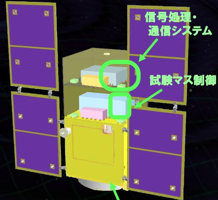
試験マスの非接触制御と精密計測
