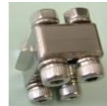
スリット型FEEPは表面処理が難しく開発難易度が高い。しかし、もし利用可能であればシステム電力が大幅に低減可能なため、研究を継続。
