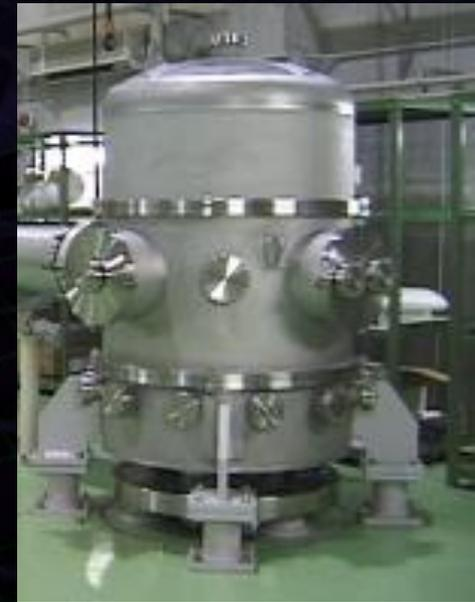
クライオスタット、冷凍機技術はKAGRAクライオスタット開発の過程で確立している。その技術を流用することで、立ち上げのための労力を削減する。
