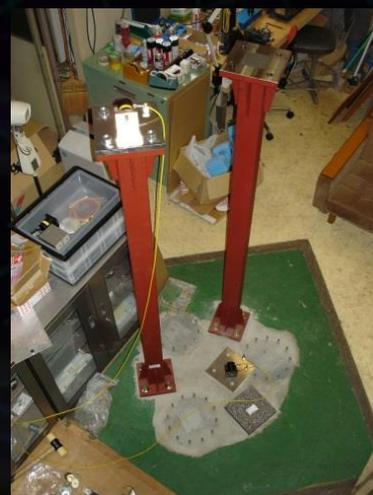
架台支柱試験品
