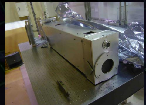
透過光用 Beam reducing telescope 長さ約1.5m (LIGO同等品)
